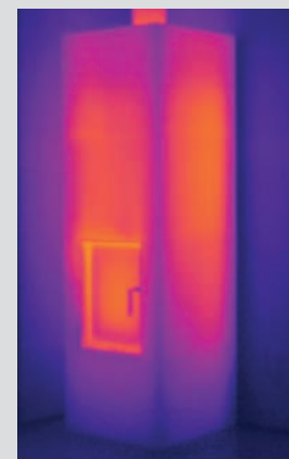
12 godzin po rozpaleniu Średnia temperatura powierzchni 45 °C
