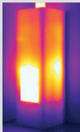
3 godziny po rozpaleniu Średnia temperatura powierzchni 88 °C
